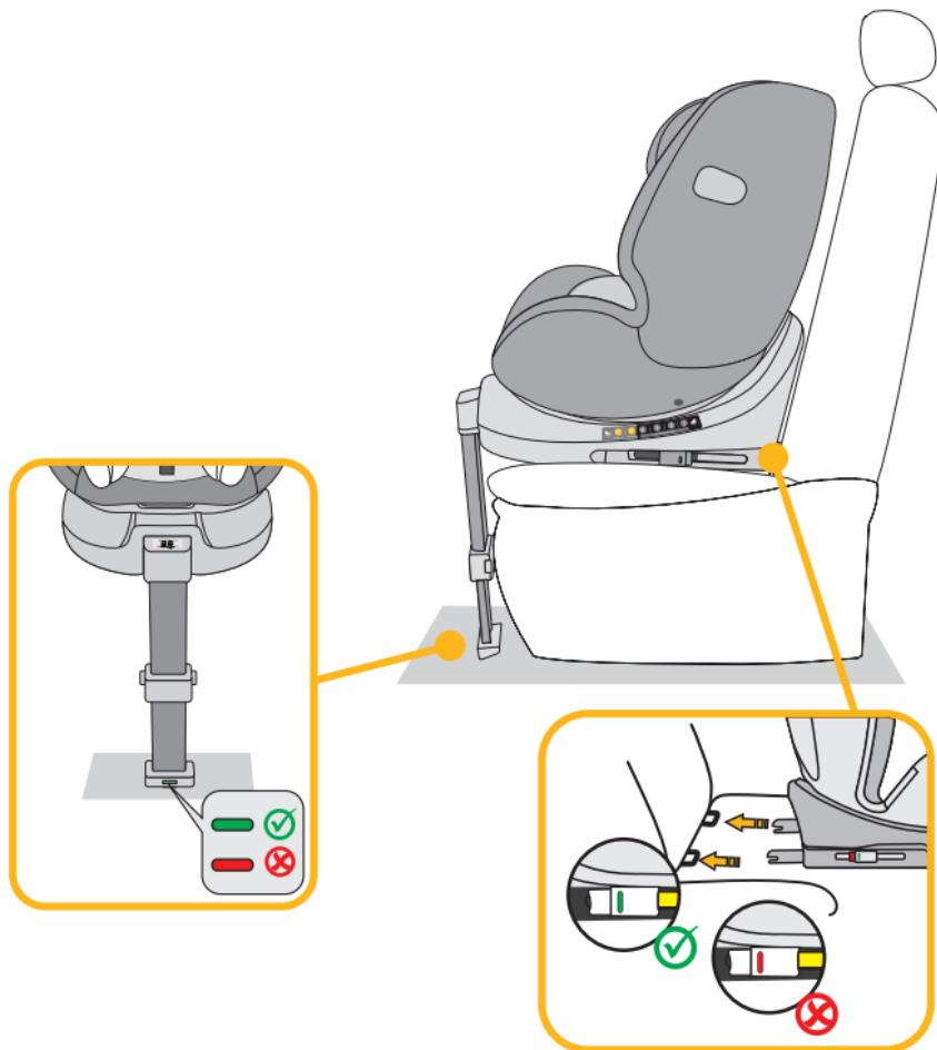
1. Pulse los dos botones laterales del conector Isofix para ampliar la longitud de los conectores Isofix.
