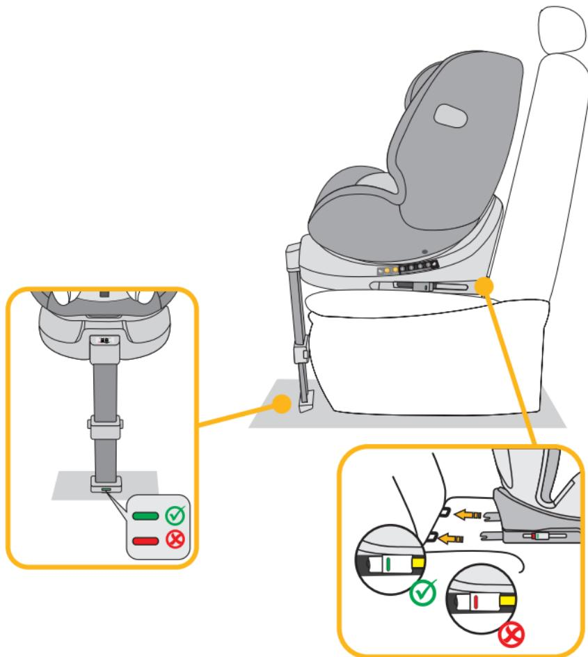
1. Druk de Isofix-connectorknoppen aan beide kanten in om de Isofix-connectoren in de lengte uit te schuiven.
