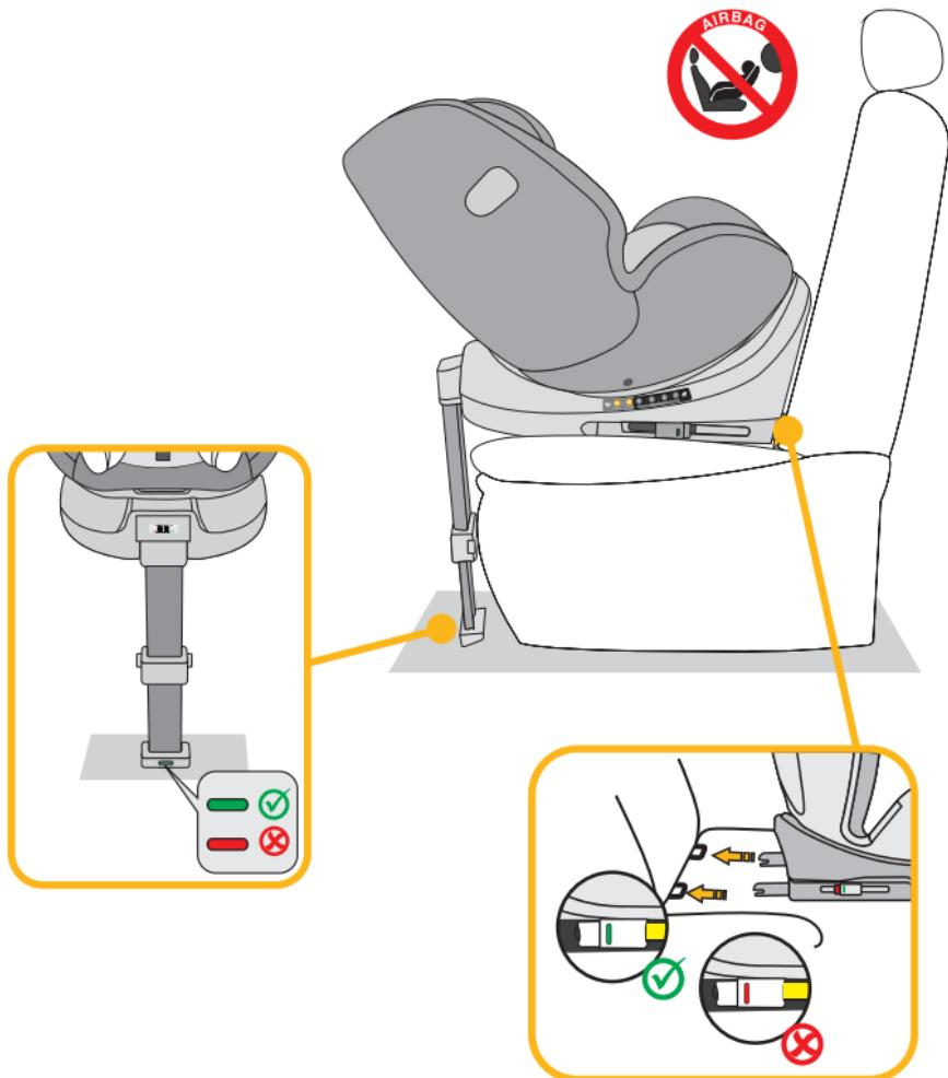
1. Detskú autosedačku nastavte do maximálnej pozície sklonu na ležanie a otočte ju tak, aby pri orientácii dozadu ukazovala na pozícii sedačky R1 – 40 – 75 cm. Ak výška dieťaťa prekračuje 75 cm, prepnite autosedačku do pozície R2 – 76 – 105 cm.
