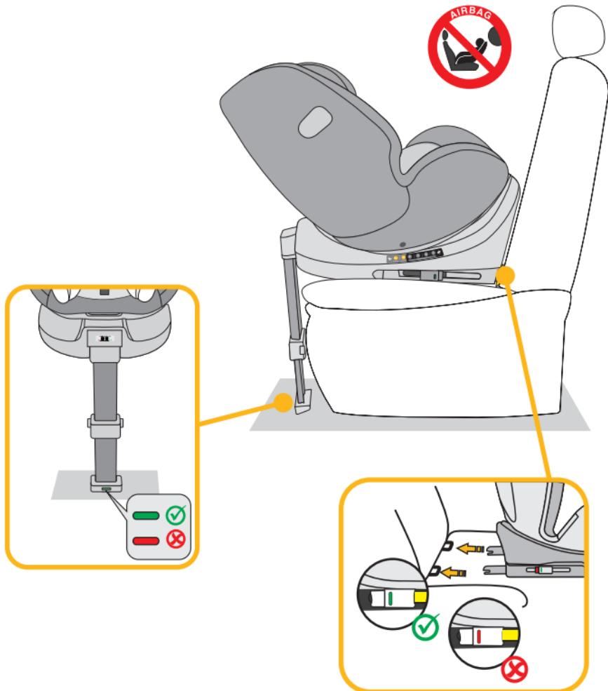
1. Réglez le siège auto à la position d'inclinaison maximale et faites-le pivoter de manière à ce qu'il soit orienté vers la position R1 – 40 – 75 cm dos à la route. Si la taille de votre enfant dépasse 75 cm, veuillez passer à la position de siège R2 – 76 – 105 cm.
